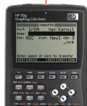
Communication sans fil à l'aide du port IrDA
