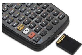
Logement de carte SD permettant l'extension de la mémoire et le transfert de données 6
