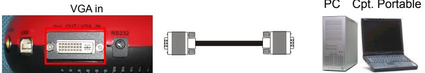
**[Notification]** Câble DVI à adaptateur VGA (facultatif) doit être utilisé.
