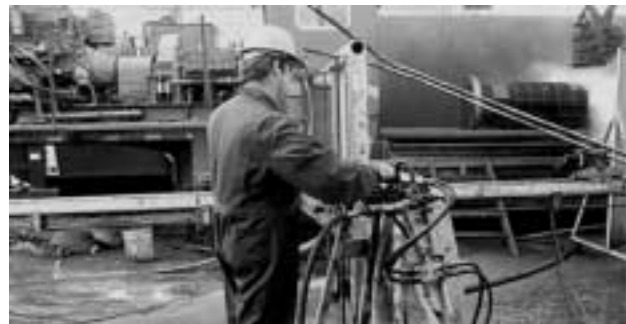
Figure 13. Poste de l'opérateur d'une machine de nettoyage au jet d'eau sous HP commandée à distance
