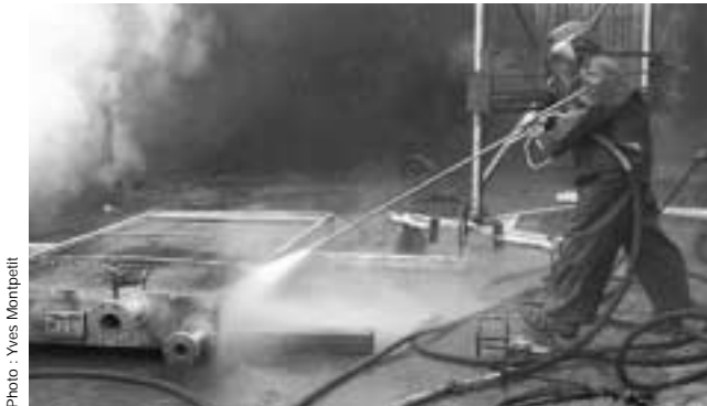
Figure 12. Travail avec un pistolet muni d'une buse balai
