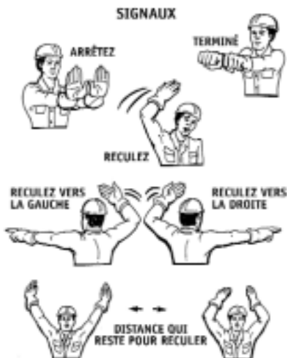
Figure 17. Code de signalisation (source : La prévention des accidents du travail lors de la collecte des ordures ménagères . Guide de prévention. Manuel du participant (APSAM et ASTE))
