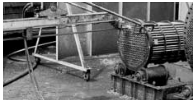
Figure 14. Tête d'une machine commandée à distance utilisée pour nettoyer l'intérieur d'un échangeur
