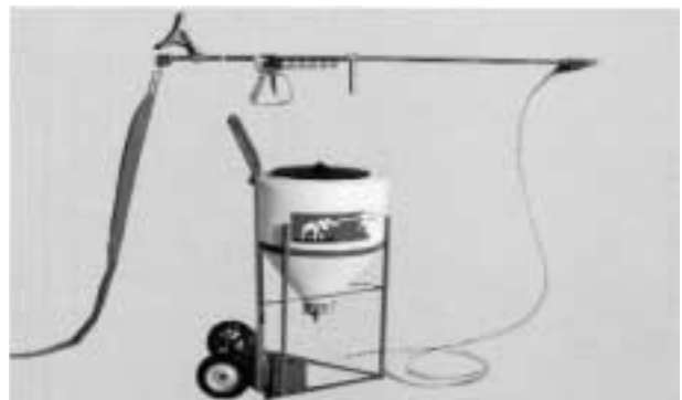
Figure 8. Ensemble de nettoyage utilisé pour le sablage humide ( wet sandblasting )
