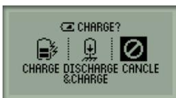
Utilisez le bouton |◀◀, ▶▶| pour passer en mode charge <charge>, puis actionnez le bouton ARRET (■) pour sélectionner le mode charge <charge>. Le mode sélectionné (CHARGE <CHARGE> ou DISCHARGE <DECHARGE>) démarre la charge automatiquement au bout d'une minute sans sélection de menu (lorsque le lecteur est raccordé à l'adaptateur CA).
