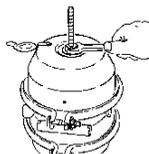
6. À l'aide d'une clé, tournez l'écrou du goujon jusqu'à ce que le ressort de compression soit détendu à 90 ou 95 %. Pendant cette opération, vérifiez que la tige-poussoir (tige-poussoir de l'adaptateur ou tige-poussoir de service) se rétracte. Ne serrez pas trop fortement le goujon. (type came en S, maximum : 50 lbf.pi (67 N.m), type à serrage en coin, maximum : 30 lbf-pi). Le frein à ressort est alors mécaniquement détendu.
