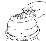
1. Déposez le bouchon du récepteur des freins à ressort.
