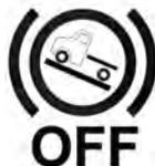
La fonction d'aide au démarrage en côte est offerte en option avec certaines boîtes de vitesses automatisées. Cette fonction maintient le véhicule immobile sur une pente de manière à permettre au conducteur de relâcher les freins de service et d'appuyer sur l'accélérateur. De plus, cette fonction empêche le véhicule de bouger s'il tente de gravir une pente depuis un arrêt qu'il soit en marche avant ou arrière.
