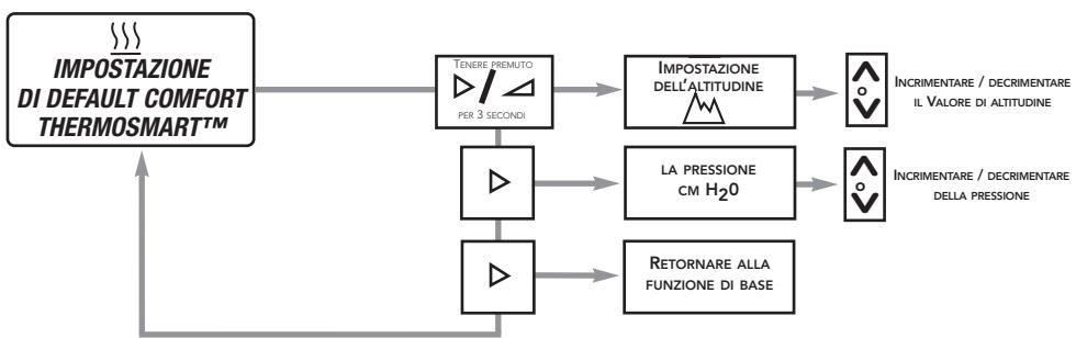
NOTA: L'aggiustamento manuale dell'altitudine non è disponibile sulle unità che dispongono della Regolazione Automatica dell'Altitudine/Compensazione delle Perdite.
