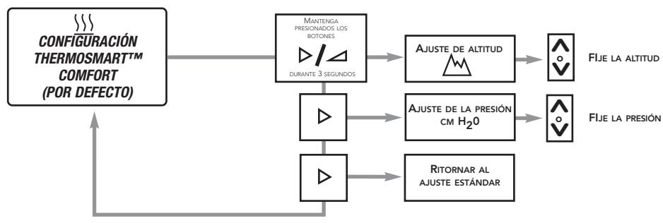
Nota: El ajuste manual de la altitud no está incluido en las unidades que contienen Ajuste de Altitud Automático/Característica de Compensación de Fuga.
