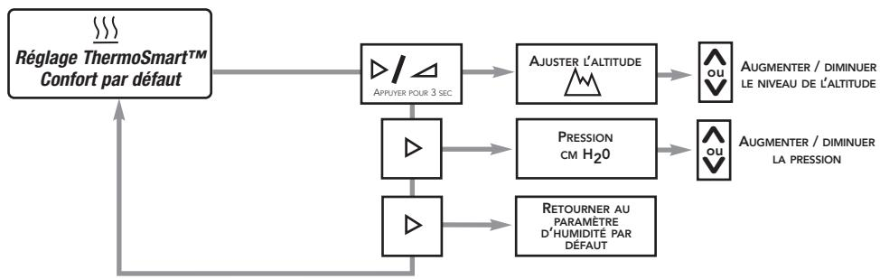
(NB) Sur les appareils possédant l'option de **compensation de fuite et ajustement automatique de l'altitude**, le réglage manuel de l'altitude n'est pas disponible.
