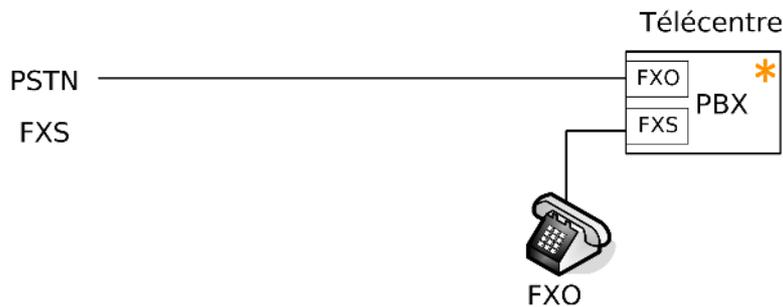
*Image 9.* Le télécentre utilise une carte TDM400P wildcard pour se connecter le PBX au PSTN (module FXO) et pour relier un téléphone analogique au PBX (module FXS).
