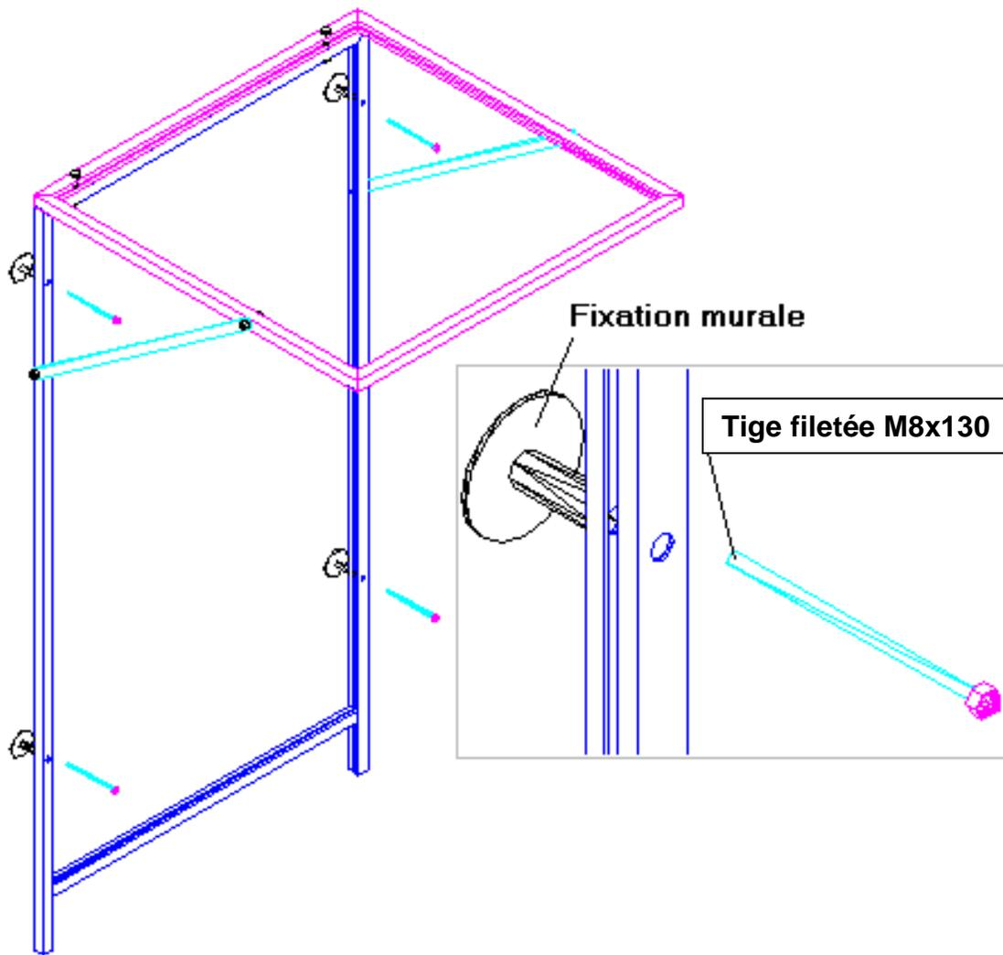
7/ Présenter le box face aux tiges et glisser le panneau mural (les trous de fixation dans l'axe des tiges)
