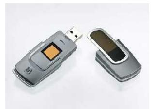
Si le doigt présenté est reconnu par le logiciel contenu dans **BioFlash**, l'accès aux données est autorisé, sinon il reste verrouillé.
