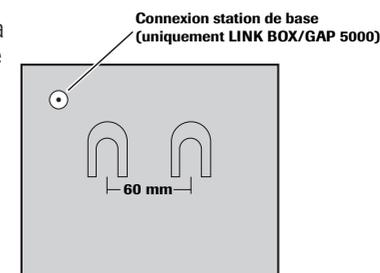
Le LINK BOX/GAP doit être enregistré sur votre base DECT/GAP avant de pouvoir être utilisé. Le processus d'enregistrement peut normalement être réalisé en utilisant la fonction « enregistrement automatique ».
