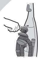
Placer la poignée sur l'aspirateur. La positionner correctement. La poignée doit être parfaitement droite sur l'appareil. Visser la grande vis (pré-montage dans le trou supérieur). Visser la petite vis dans le trou inférieur et la serrer. Contrôler si le réceptacle à poussière est en place.
