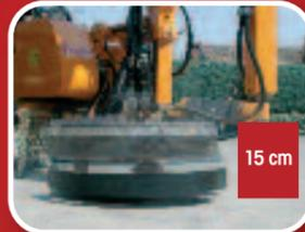
Système d'autonivellement des disques de fauchage.
