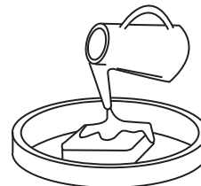
FIGURE 35 : Lavage du filtre à air
