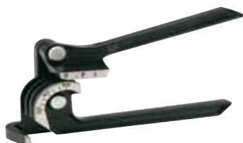
368 : Rayon cintrage court - possibilité de cintrer jusqu'à 90°. Type triple têtes pour tubes 1/4" - 5/16" - 3/8" OD.
