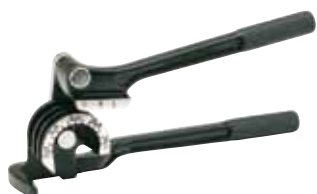
368-180 : Rayon cintrage court - possibilité de cintrer jusqu'à 180°. Type triple têtes pour tubes 1/4" - 5/16" - 3/8" OD.
