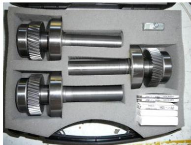
Possibilité également de créer des défauts vibratoires par désalignement du système (obtenu par dérèglement du système)
