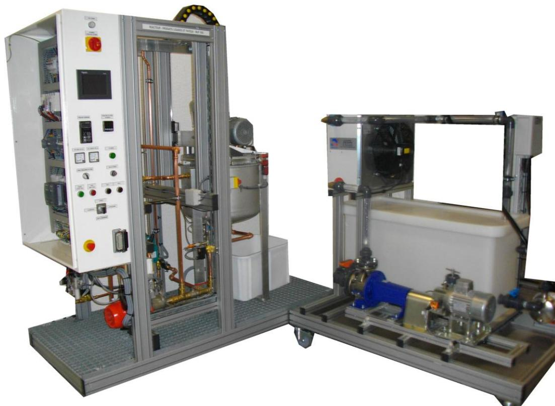
illustration réacteur + module de recyclage(partie droite)
