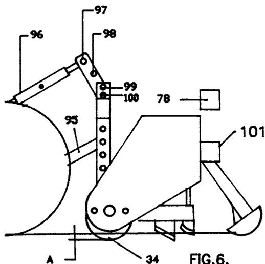
Le réglage de la profondeur de coupe du sol est donc une opération dynamique lorsque l'élément basculant 97 peut bouger librement. Lorsque l'élément basculant 97 est bloqué, le semoir VERTI-SEED reposera sur les socs arrière des éléments de semis permettant ainsi de régler la profondeur de travail d'une manière statique. Dans ce cas, le VERTI-SEED n'épousera pas toutes les irrégularités du sol.
