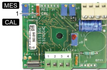
Figure 15 : circuit principal du CTX 300 SC.
