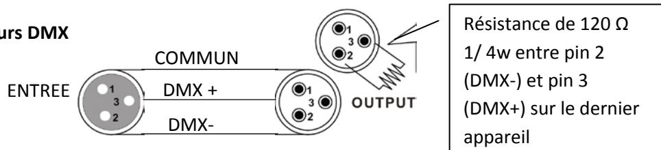
La résistance de fin de ligne réduit les erreurs de signal. Pour éviter des problèmes de transmission des signaux, il est toujours conseillé de brancher une résistance de fin de ligne DMX.
