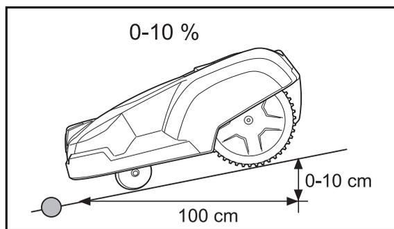
Le câble périphérique ne doit pas être posé en travers d'une pente d'une inclinaison supérieure à 10 %. Automower aurait du mal à tourner. La tondeuse s'arrête et affiche le message d'erreur *En dehors zone de tonte*. Le risque est particulièrement important par temps humide dans la mesure où les roues risquent de déraiser dans l'herbe mouillée.
