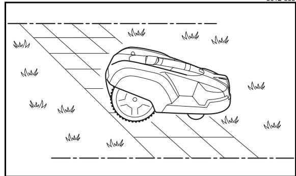
Remarque ! Automower ne peut pas traverser une allée en gravillons. Risque d'endommagement des lames !
