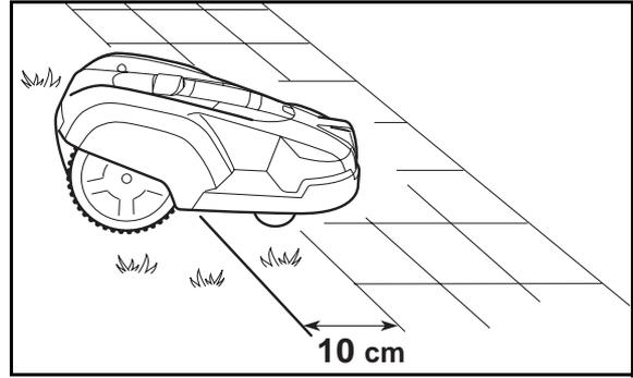
Si la zone de travail est divisée par une allée dallée de même niveau que la pelouse, il est possible de laisser Automower traverser l'allée. Le câble périphérique peut très bien être posé sous les dalles. Il est également possible de loger le câble périphérique dans les rainures entre les dalles.
