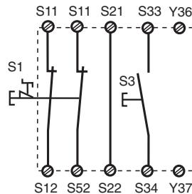
Fig. 4: Eingangskreis zweikanalig, ohne Querschlusserkennung, überwachter Start/Two-channel input circuit, no short circuit detection, monitored reset/Commande par 2 canaux, sans détection de court-circuit, surveillance du poussoir de validation
