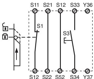
Fig. 5: Control de puerta protectora monocanal, rearme supervisado/Controllo monocanale riparo mobile, start controllato/Eenkanalige hekbewaking, bewaakte start
