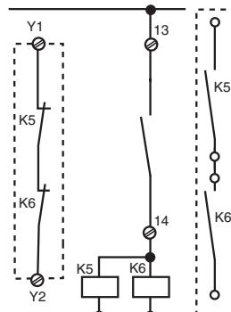
Fig. 9: Ejemplo de conexión para contactores externos, monocanal, rearne automático/Esempio di collegamento per relè esterni, monocanale, start automatico/Aansluitvoorbeeld van externe magneetschakelaars, eenkanalig, automatische start
