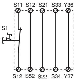
Fig. 2: Eingangskreis einkanalig, autom. Start/Single-channel input circuit, automatic reset/Commande par 1 canal, validation automatique
