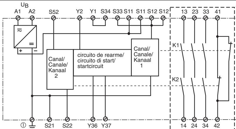
Fig. 1: Esquema de conexiones eléctricas/Schema di collegamento interno/Intern schema
