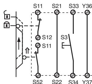
Fig. 7: Schutztürsteuerung zweikanalig, ohne Querschlusserkennung, nicht überwachter Start/Two channel safety gate control, no s/c detection, reset not monitored i.e. manual reset /Surveillance de protecteur, commande par 2 canaux, sans détection de court-circuit, validation non surveillée
