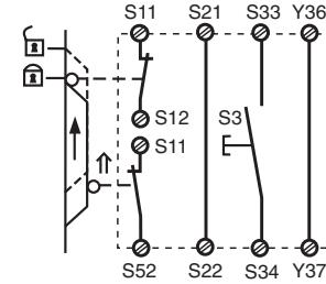
Fig. 7: Control de puerta protectora bicanal, sin detección de corto circuito transversal, rearne no supervisado/Controllo bicanale riparo mobile, senza rilevamento del cortocircuito trasversale, start non controllato/Tweekanalige hekbewaking, zonder detectie van onderlinge sluiting, niet bewaakte start
