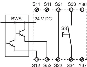
Fig. 8: Control de barrera fotoeléctrica, bicanal, detección de corto circuito transversal mediante BWS, rearne supervisado/Controllo barriera fotoelettrica, bicanale, rilevamento del cortocircuito trasversale mediante photocellula, start controllato/Tweekanalige lichtschermbewaking, detectie van onderlinge sluiting door lichtscherm, bewaakte start
