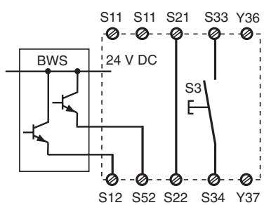
Fig. 8: Lichtschrankensteuerung, zweikanalig, Querschlusserkennung durch BWS, überwachter Start/Dual-channel light curtain control, short circuit detection via BWS, monitored reset/Commande par 2 canaux par barrage immatériel, surveillance du poussoir de validation
