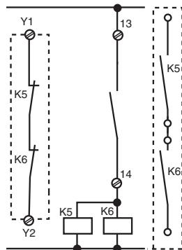
Fig. 9: Anschlußbeispiel für externe Schütze, einkanalig, automatischer Start/Connection example for external contactors/relays, single-channel, automatic reset/Branchement contacteurs externes, commande par 1 canal, validation automatique
