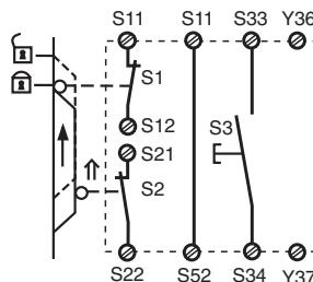
Fig. 6: Control de puerta protectora bicanal, con detección de corto circuito transversal, rearme supervisado/Controllo bicanale riparo mobile, con rilevamento del cortocircuito trasversale, start controllato/Tweekanalige hekbewaking, met detectie van onderlinge sluiting, bewaakte start
