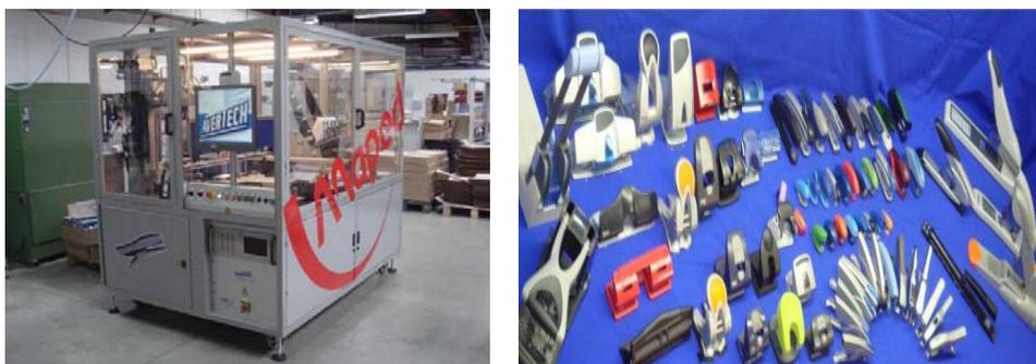
Figure 83 : Banc de test automatique d'agrafeuse et de perforateur Maped
