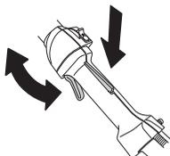
Voir le chapitre Démarrage. Démarrer la machine et donner les pleins gaz. Relâcher l'accélérateur et s'assurer que l'équipement de coupe s'arrête et qu'il reste immobile. Si l'équipement de coupe tourne lorsque l'accélérateur est au régime de ralenti, contrôler le réglage du ralenti du carburateur. Voir le chapitre Entretien.
