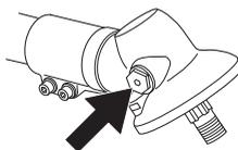
En général, il n'est pas nécessaire de remplacer le lubrifiant du carter, sauf en cas de réparations.
