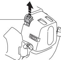
**Pompe à carburant:** Appuyer sur la poche en caoutchouc de la pompe à carburant plusieurs fois jusqu'à ce que le carburant commence à remplir la poche. Il n'est pas nécessaire de remplir la poche complètement.
