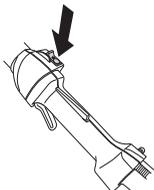
Mettre le moteur en marche et s'assurer qu'il s'arrête lorsque le bouton d'arrêt est amené en position d'arrêt.
