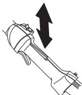
Vérifier que le blocage de l'accélération, la commande d'accélération et leurs ressorts de rappel fonctionnent correctement.
