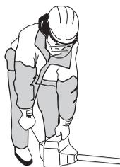
**REMARQUE!** Ne pas placer aucune partie du corps sur la surface marquée. Contact peut causer en brûlures à la peau ou les chocs électriques si le chapeau de bougie est defectueux. Toujours utiliser des gants. Ne jamais utiliser une machine dont le chapeau de bougie est defectueux.
