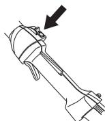
**REMARQUE!** L'interrupteur d'arrêt se remet automatiquement en position de démarrage. Toujours
