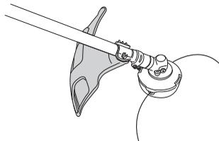
S'assurer que la protection est intacte et qu'elle ne présente pas de fissures. Remplacer la protection si elle a subi des coups ou si elle présente des fissures.
