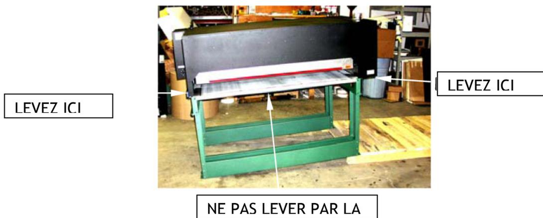
4/ Positionnez la partie avant (sans le moteur) sur le sol en face du tunnel comme indiqué sur la photo. Placez les vis et boulon de fixation prévue a cet effet, en maintenant la sortie. Ne pas serrez à fond.
