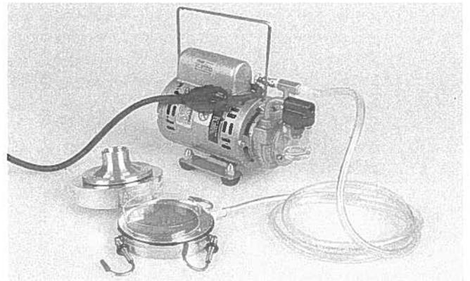
Figure 13. Échantillonneur d'air Anderson à une étape, avec boîte de Pétri.
