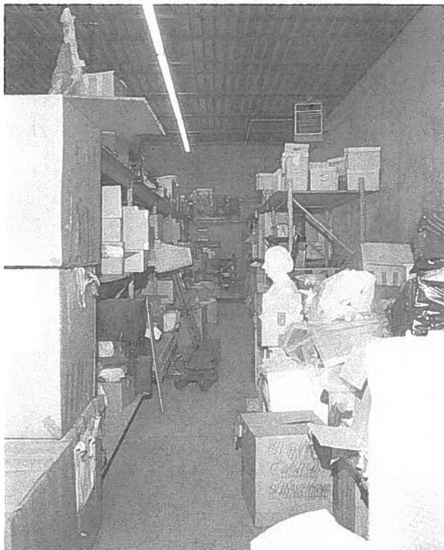
Figure 10. Le positionnement incorrect des enceintes de rangement bloque la circulation de l'air.
