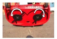
Avant toute intervention sur le plateau de coupe pour opérations de nettoyage, réparation, entretien, réglage, etc., débrayez la prise de force, arrêtez le moteur et retirez la clé de démarrage.
