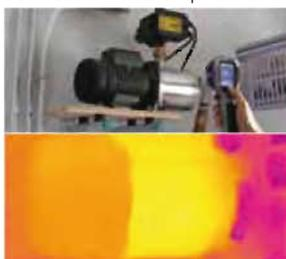
L'inspection de cette pompe à eau permet de constater qu'il n'y a aucun problème. L'image thermique prouve la présence d'eau dans le cylindre. Aucun danger de surchauffe.
