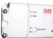
Le variateur peut être fixé avec 2 vis (diamètre <3mm) avec les languettes en plastiques disposés en diagonale.
