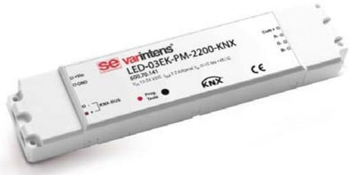
Le variateur LED est utilisé pour le contrôle de 3 circuits LED composé de bandes lumineuses strip LED réglé en tension. Les diodes lumineuses peuvent être variées en intensité lumineuse entre 0 et 100% en modifiant le courant de LED par modulation de la largeur des impulsions.
