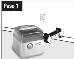
Seleccione una ubicación firme y plana alejada al menos 15 cm de cualquier pared para la circulación apropiada de aire. Coloque el humidificador sobre una superficie resistente al agua, ya que el agua puede dañar sus muebles o algún tipo de piso.
