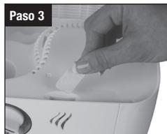
Inserte la almohadilla de aroma en la ranura con el lado del ángulo apuntando hacia abajo. Usted puede utilizar la bolsa para sostener la almohadilla durante la colocación.
