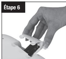
Replacer le volet et les vis puis réassembler l'appareil.
