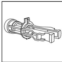
**5** Pour remettre le filtre en place, ou installer un nouveau filtre, s'assurer d'abord que le filtre est correctement orienté avec la languette en plastique dirigée vers le haut. Si le filtre n'est pas correctement orienté, la languette saillante empêchera le filtre de glisser jusqu'à son emplacement initial.
