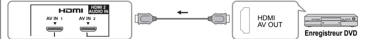
● La connexion aux bornes HDMI permet l'obtention d'une image numérique haute définition et un son de haute qualité.
