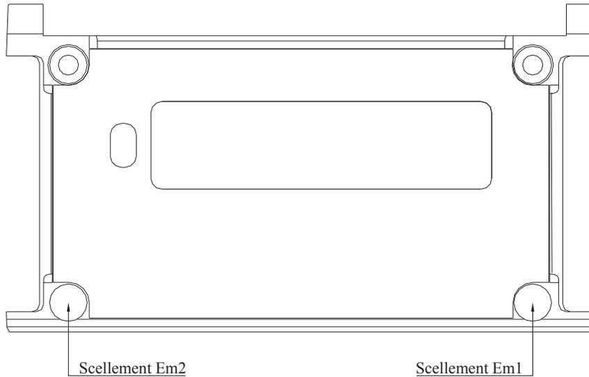
Les scellements Em1 et Em2 masquent les vis permettant de démonter le calculateur indicateur. Il faut démonter le boîtier pour accéder à l'interrupteur qui permet de passer en mode "métrologique" afin de modifier le paramétrage du calculateur indicateur.
