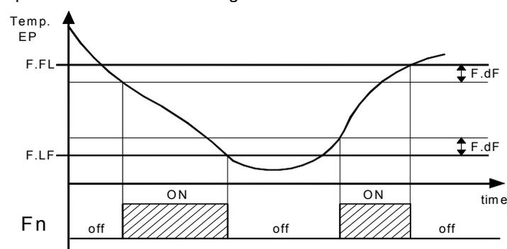
Note: Une attention particulière devrait être la correct utilisation des fonctions de contrôle des ventilateurs en fonction de la température parce que dans une application typique du ventilateur de l'évaporateur de réfrigération s'arrête bloquant le transfert de chaleur.
