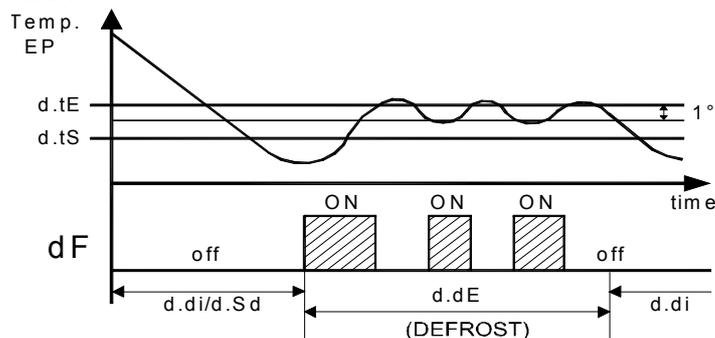
Exemple de dégivrage électrique avec fonction de thermostat : le dégivrage s'arrête à la fin des temps "d.dE". Pendant le dégivrage de la sortie configurée comme dF est activé/deconnecté comme un contrôleur de température tout ou rien en mode chauffage avec hystérésis de 1 ° afin de maintenir une température de dégivrage constante à la valeur "d.tE".
