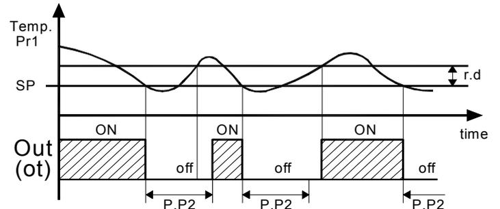
Le troisième contrôle prévoit une interdiction à l'activation de la sortie "ot" si, depuis que la sortie a été activée la dernière fois, le temps programmé au paramètre "P3" (retard entre les activations) n'est pas passé.
