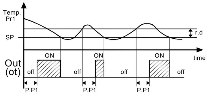
Le deuxième contrôle prévoit une interdiction à l'activation de la sortie "ot" si, depuis que la sortie a été désactivée, le temps programmé au paramètre "P2" n'est pas passé (retard après l'extinction ou temps minimum d'extinction).
