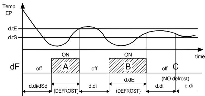
Exemples du fin dégivrage: le dégivrage A termine pour la réalisation de la température "d.tE", le dégivrage B termine à la fin du temps "d.dE" car la température "d.tE" n'est pas réalisée, le dégivrage C ne s'effectue pas car la température est supérieure à "d.tS".
