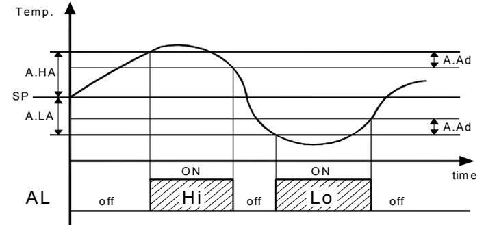
Les alarmes de température de maximum et de minimum peuvent être déconnectées en établissant les paramètres relatifs "A.HA" et "A.LA" = oF.
