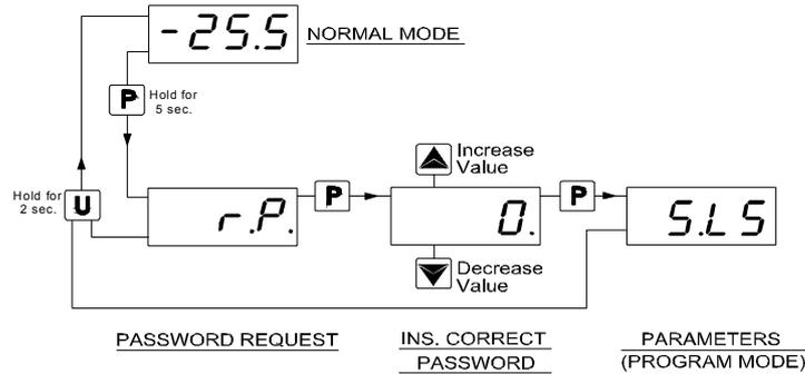
**Notes :** Si l'on oublie la Password, il faut enlever l'alimentation à l'instrument, appuyer sur la touche P et redonner de l'alimentation à l'instrument en laissant appuyer la touche pour plus de 5 sec.. On aura ainsi accès aux paramètres protégés et on pourra donc vérifier et modifier aussi le paramètre "t.PP".
