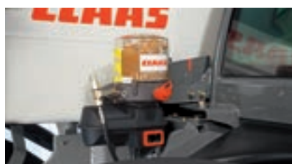
Système de graissage centralisé pour le graissage automatique de tous les points de graissage
