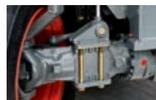
Blocage de l'essieu pendulaire arrière
