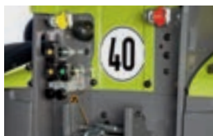
Raccords hydrauliques à l'arrière avec réservoir d'huile de fuite et freinage pneumatique de remorque
