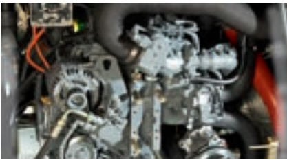
Le montage des moteurs à 90° par rapport au sens d'avancement permet un accès aisé à tous les points de contrôle et d'entretien.
