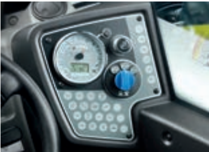
La gamme choisie et le sens d'avancement sont affichés à droite sur le tableau de bord.
