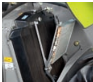
L'accessibilité du groupe de radiateurs sous le capot moteur est optimale.
