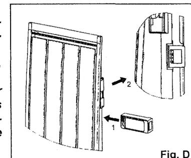
Pour mettre le programmeur dans l'appareil :
