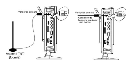
Connectez l'antenne TNT fournie ou une antenne externe afin de recevoir respectivement le signal TV numérique ou analogique.
