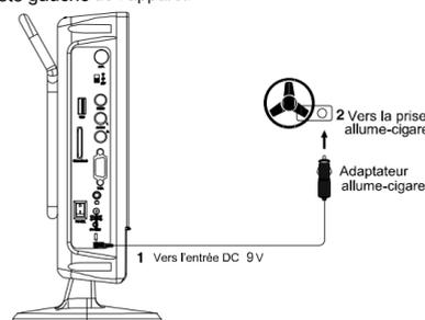
AVERTISSEMENT : Débranchez l'adaptateur allume-cigare lorsque l'appareil n'est pas en cours d'utilisation. Ne convient pas aux véhicules avec système électrique 24 V.
