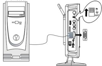
Utilisez un connecteur mini D-Sub à 15 broches (non fourni) pour relier votre ordinateur à l'entrée VGA située sur le côté gauche de l'appareil. Placez le commutateur **AV IN/OUT** en position « IN » pour que l'appareil reçoive le signal.
