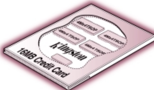
De l'extérieur, la mémoire credit card ne ressemble guère à un module classique. A l'intérieur, on retrouve pourtant les puces mémoire TSOP standard.
