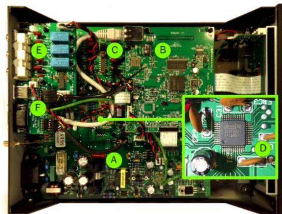
Le réglage de volume est confié à un circuit intégré PGA2320 de Texas Instruments qui comprend un réseau de résistances commutées agissant sur le gain d'un amplificateur opérationnel intégré.
