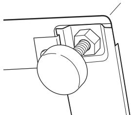
**NOTA:** Para minimizar la vibración, las tuercas de fijación deben estar bien ajustadas.
