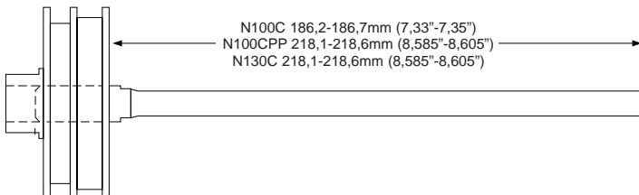
**NOTA:** Un desgaste del impulsor de aproximadamente 3mm (1/8") se puede tolerar para la mayoría de las aplicaciones. Sin embargo, para aplicaciones de impulsión difíciles, un desgaste del impulsor de aproximadamente 1,5 mm (1/16") puede causar una ligera reducción en la potencia de impulsión aparente.
