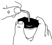
Afloje el tornillo según se muestra. Ajuste a la dirección de escape deseada y apriete el tornillo.
