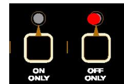
L’action Sous tension/ Hors tension seulement (ON/OFF only) est programmée par défaut dans le contrôleur.
