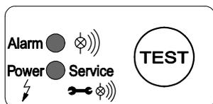
Lors de l'application de la tension d'alimentation électrique, le BEKOMAT® 32U effectue un **autotest**. Les deux LED sont allumées pendant 1 seconde environ, puis l'appareil passe à l'état "**Prêt à fonctionner**".
