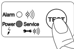
Avant de remplacer l'unité de maintenance, il faut effectuer un reset. L'unité de commande doit être détachée en appuyant sur le clip de maintien. Après le retrait, il faut actionner la touche TEST pendant 5 secondes au moins.
