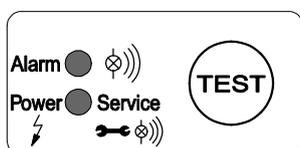
Si l'écoulement du condensat est perturbé, un mode alarme est activé et signalé par le clignotement de la LED d'alarme rouge.
