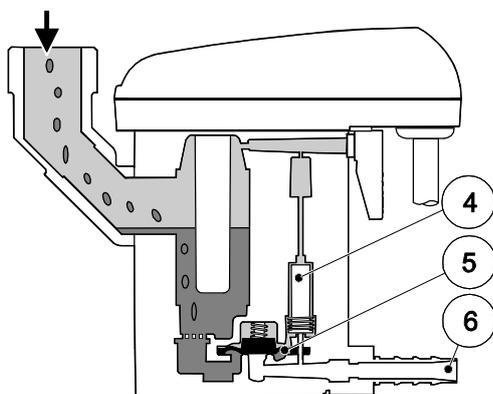
L'électrovanne pilote (4) est activée et la membrane (5) ouvre la conduite d'évacuation (6) pour l'éclusage du condensat.
