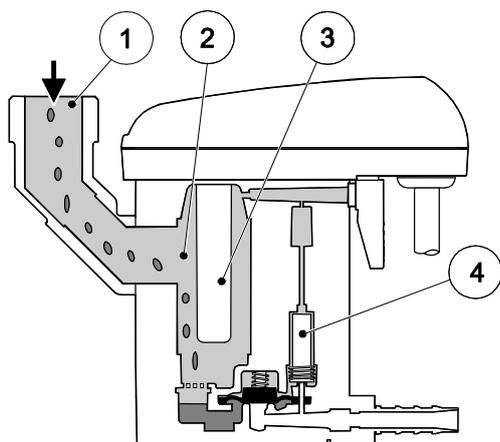
Amené dans le BEKOMAT® 32U F par la conduite d'amenée (1), le condensat est collecté dans le corps (2).
