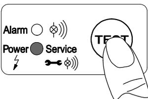
Test du fonctionnement de l'électrovanne (purge manuelle) : Appuyer sur le bouton pendant 2 secondes environ.
