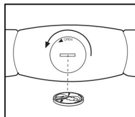
Retirez la vieille pile de l'unité du détecteur. Insérez une nouvelle pile, en vous assurant que les lettres sont au-dessus. De plus, assurez vous que la rondelle en caoutchouc est à sa place dans l'unité du détecteur. Refermez le couvercle de la pile et tournez-le dans la position fermée.
