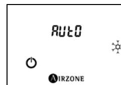
Fig. 11 - Thermostat maître avec vitesse en mode Auto
