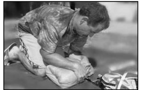
Faites glisser le sac de déploiement sous le paquet formé tout en le tenant et insérez l'ensemble par les côtés dans le sac de déploiement.
