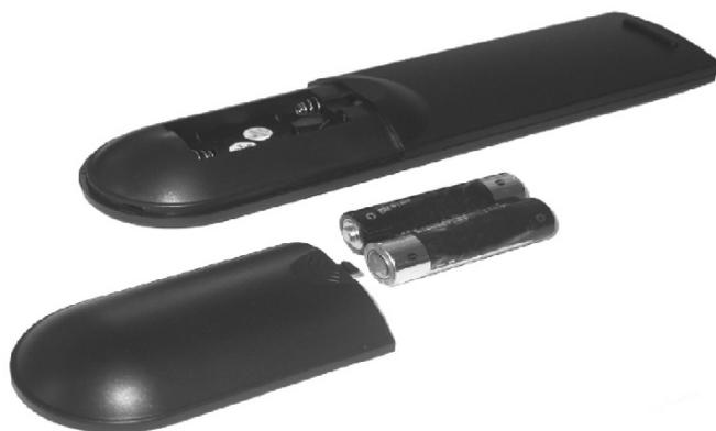
2. Installez 2 piles AAA (1.5V) Faites correspondre les signes + et – sur les piles avec ceux qui se trouvent dans le compartiment des piles.
