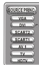
Si vous ne pouvez pas trouver votre télécommande immédiatement, ne vous tracassez pas, il y a une autre façon de sélectionner la source de signal. Appuyez sur la touche <TV/AV> du panneau de commande avant, un Menu OSD Source s'affichera à l'écran. Appuyez sur la touche <Chaîne suivante> ou <Chaîne précédent>, vous pouvez sélectionner la source de Signal, appuyez sur la touche <Augmenter volume> pour confirmer votre sélection.
