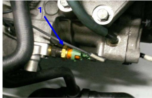
**Capteur de position barillet (Potentiomètre)**
