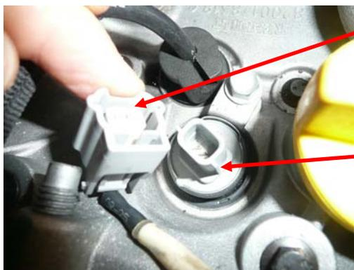
**Contacteur de coupure moteur (Up-shift)**
