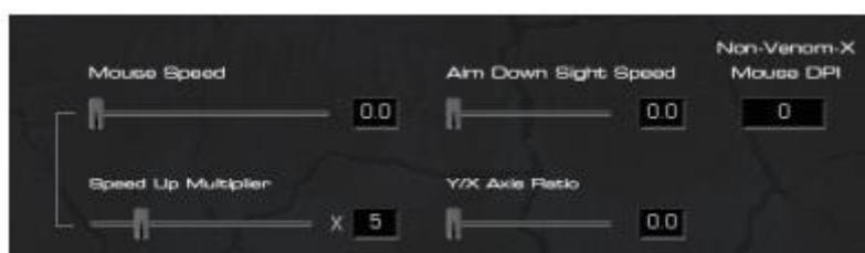
Venom-X peut amplifier ou désamplifier les données de suivi brut de la souris pour changer la vitesse de déplacement, la vitesse de la visée peut être réglée par la "Vitesse de la souris" avec la barre de défilement. La valeur est affichée dans la case à droite de la barre de défilement. Les données de suivi de la souris est amplifiée lorsque la valeur du facteur est supérieur à 1,0, et atténué lorsque le facteur est inférieur à 1,0.
