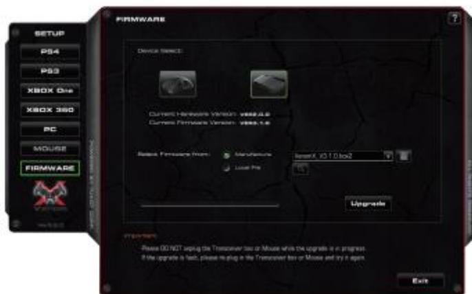
Le boîtier de transmission et la souris Venom-X ont leurs propre firmware, ils n'ont pas nécessairement besoin d'être mis à jour en même temps. Vous ne pouvez mettre à jour qu'un firmware à la fois. Faites glisser le commutateur "Sélection de la plate-forme" de la boîte de transmission à la position "PC", puis connectez le au PC via un port USB pour mettre à jour le boîtier de transmission.
