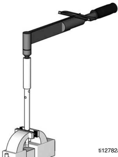
FIG. 2. Enlever l'écrou de transit
