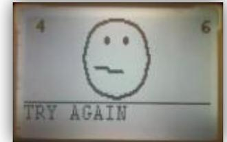
Si les vibrations de la machine sont trop importantes ou si un élément a bougé pendant le test, le système indique le défaut par l'intermédiaire de l'écran ci-dessus.
