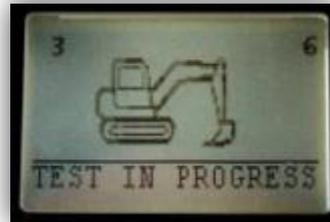
Un long beep indique la fin du test de vibration, suivi d'une horloge indiquant le temps restant pour la calibration.
