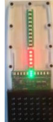
Faisceau laser au centre du récepteur (les deux barres LED horizontale & verticale vertes)
