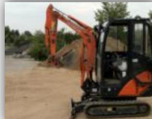
Abaisser lentement le balancier jusqu'au signal sonore d'un beep long confirmant que le capteur est correct.
