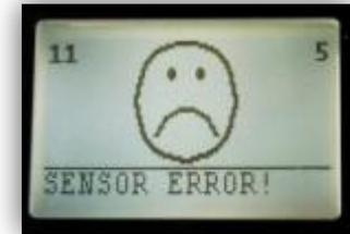
Si le système ne détecte pas les mouvements des capteurs, vérifier le symbole indiqué sur chaque capteur et le bon emplacement de ceux-ci.
