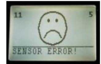
Si le Système ne détecte pas le capteur laser :
