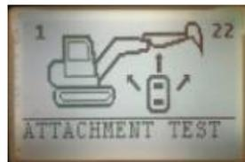
Si le système entre automatiquement en fonction "Test de liaison" après la mesure du 5<sup>ème</sup> point, veuillez exécuter le test et répéter le contrôle des 5 points.
