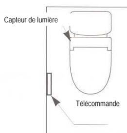
1. Si la télécommande ne peut être montée sur un mur du côté gauche de la toilette, la disposer sur le mur du côté droit, en un point qu'il sera facile d'atteindre lorsque assis sur la toilette. Répéter ensuite la procédure de test expliquée plus haut. Si la lampe d'indicateur de marche clignote, la télécommande peut être installée à cet endroit. Sinon, il sera nécessaire d'installer un réflecteur pour permettre au signal de la télécommande d'atteindre le capteur de lumière sur le corps
